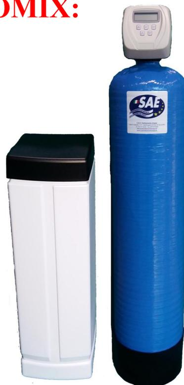
Il sistema *ECOMIX* funziona come un normale addolcitore e dovrebbe essere usato quando oltre all'addolcimento è necessario rimuovere il *FERRO* e/o il *MANGANESE* dall'acqua. Non necessita di nessun trattamento aggiuntivo (ossidazione o clorazione). Il sistema SI RIGENERA A SALE (NaCl). Il sistema inoltre rimuove l'*AMMONIACA*, diminuisce del 50% l'*IDROGENO SOLFORATO* (H<sub>2</sub>S) e del 50% le *SOSTANZE ORGANICHE*.
