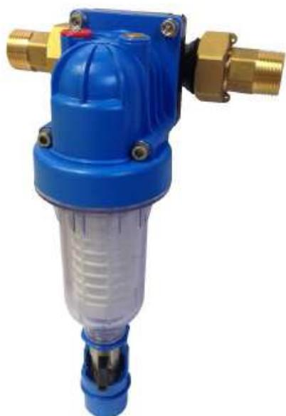
Filtro autopulente semi automatico, funzionamento a ciclone con flusso elicoidale con testa ruotabile di 360°. Uso domestico e tecnologico per il trattamento acqua potabili in generale a pH neutro, per la filtrazione di particelle in sospensione e sedimenti.
